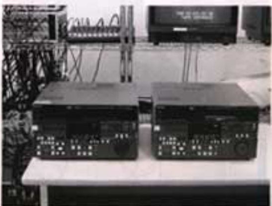
素材をエンコーダーに戻り出すためのデジタルベータカム
