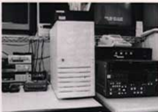
今回新たに導入されたMPEG2エンコーダー-CCE Proの筐体。エンコーディングエンジン自体はすべてソフトウェアで構成されている
